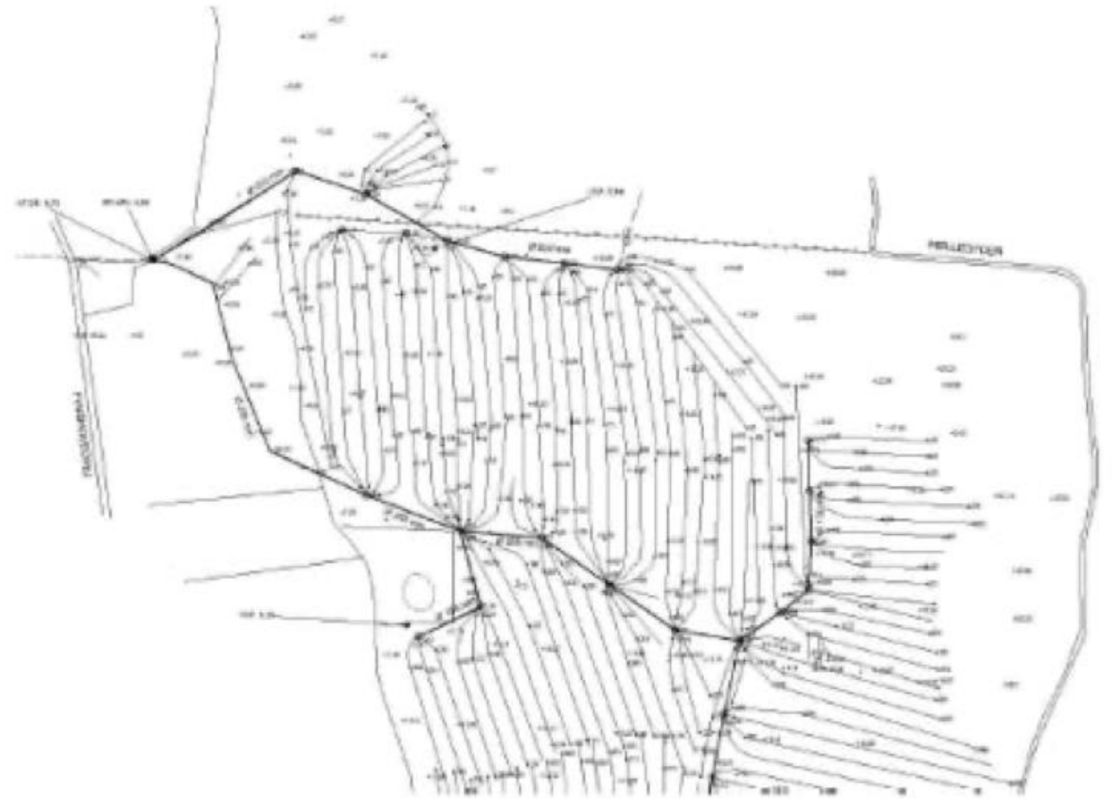
Figur 9. Eksempel på projekt hvor drænene er ført til brønd
