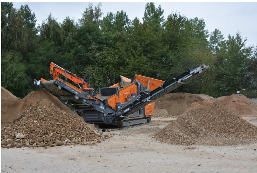
Figur 4: Karsten Reinharts støjsvage sorteringsanlæg, der sorterer kalkstabiliseret, recirkulerbart råstof for småsten og større sten. Lastbiler ankommer med opgravet byjord, der deponeres til prøvetagning og kalkstabilisering, og kører fra pladsen med sorteret, kalkstabiliseret jord, der kan erstatte rent grus.
